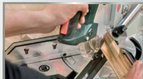
Dvojitý liniový laser k přesnému zobrazení řezné linie vlevo a vpravo od pilového listu
