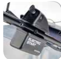
EI. start s vlastním dobíjením za chodu motoru
