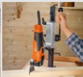
Stacionární použití v stojanu na vrtačky.
