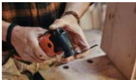
... jednoduše nastavte příslušenství do upínání Starlock v pozici a klikněte. Hotovo.
