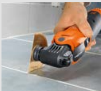
Pilové kotouče o tloušce 1,2 mm dokážou vyříznout i velmi úzké spáry.
