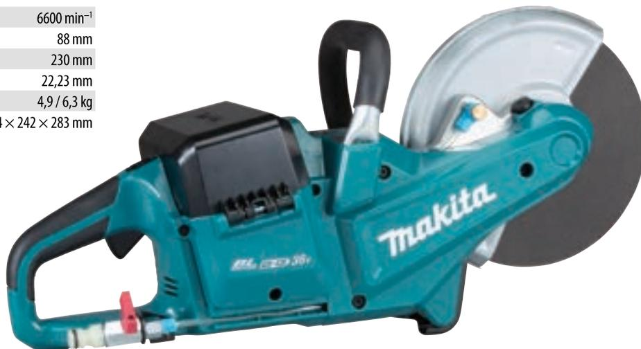
Extrémně silná rozbrušovací pila s kotoučem 355 mm. Stroj má silný bezuhlíkový motor 3,6 kW, systém AFT, který vypne motor v případě náhlé změny v zatížení, elektrickou brzdu kotouče, světelnou signalizaci přetížení stroje, elektronickou kontrolu zatížení, pozvolný rozběh, odolnost proti prachu a vodě, beznástrojový systém upínání krytu a maximální hloubku řezu 127 mm.
